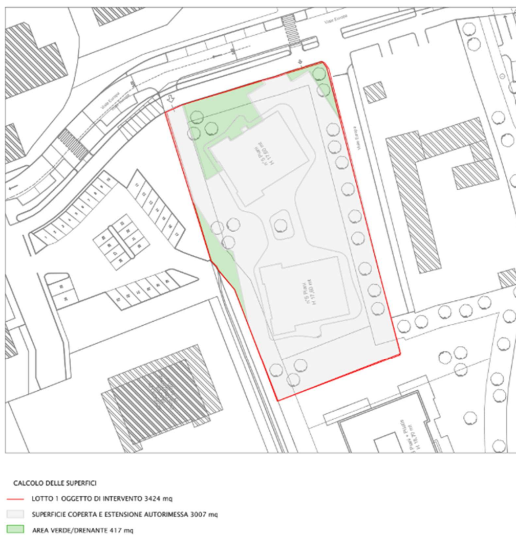
Figura 4 - Area di intervento e relative tipologie realizzative
