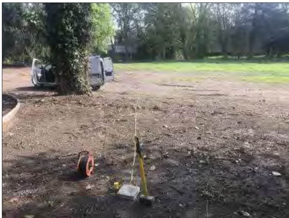
- Stesa sismica MASW Edificio B -
