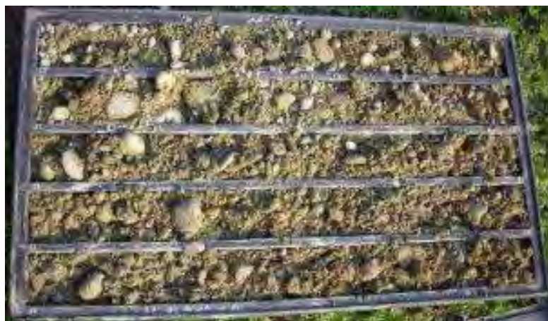
Foto 18 – Sondaggio S3 : da -25 a -30 m
