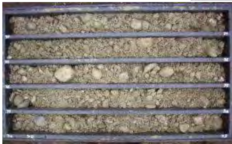
Foto 25 – Sondaggio S4 : da -30 a -35 m
