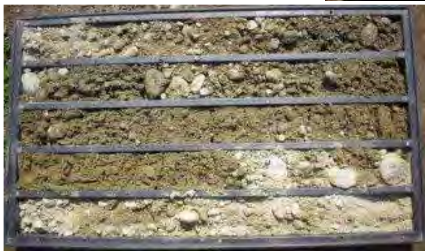
Foto 21 – Sondaggio S4 : da -10 a -15 m
