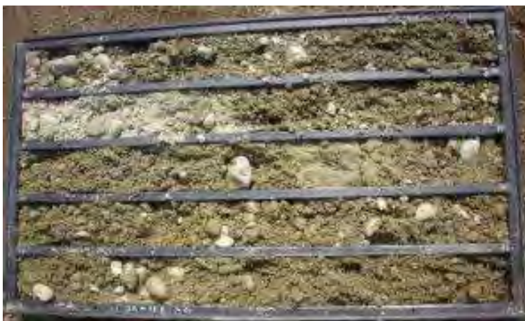
Foto 16 – Sondaggio S3 : da -15 a -20 m
