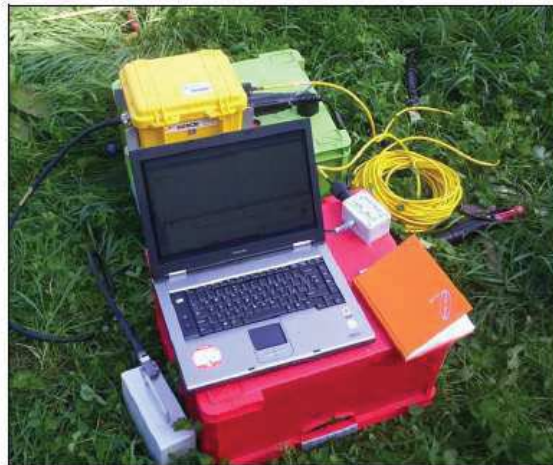
Figura 2: Strumentazione utilizzata per la prova MASW.
