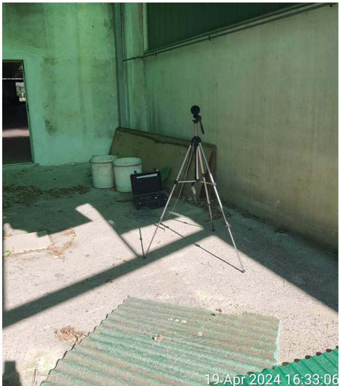
Foto n°3 – Punto di misura n°2 interno al lotto, esposizione verso via Monte Albenza
